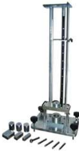
Hình 2.10. Thiết bị kiểm tra độ bền va đập chuẩn Dupont
