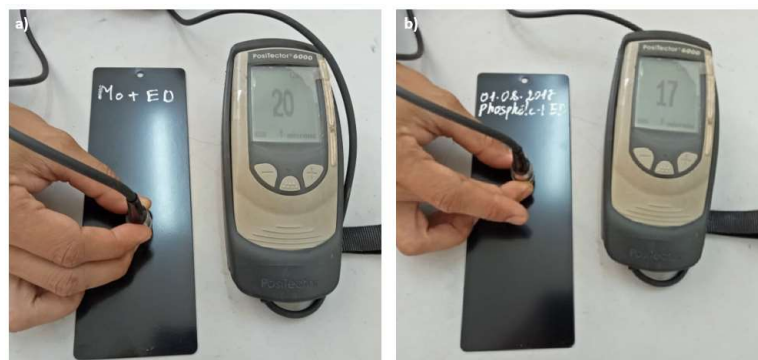
Hình 3.35. Độ dày màng sơn của a) màng sơn Zr/Ti/Mo-tĩnh điện, b) màng sơn kẽm photphat-tĩnh điện.
