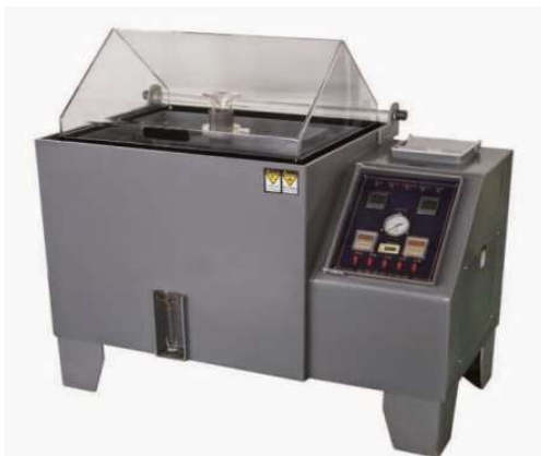
Hình 2.17. Thiết bị phun sương muối (Model SAM Y90-Đài Loan)
