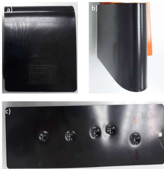
Hình 3.36. Bề mặt của lớp phủ Zr/Ti/Zr sau khi kiểm tra a) độ bám dính bằng phương pháp rạch, độ cứng; b) độ bền uốn và c) độ bền va đập.
