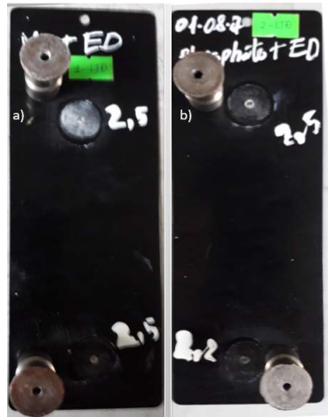
Hình 3.37. Bề mặt kiểm tra độ bám dính bằng phương pháp thủy lực của a) màng sơn Zr/Ti/Mo-tĩnh điện và b) màng sơn kẽm photphat-tĩnh điện.
