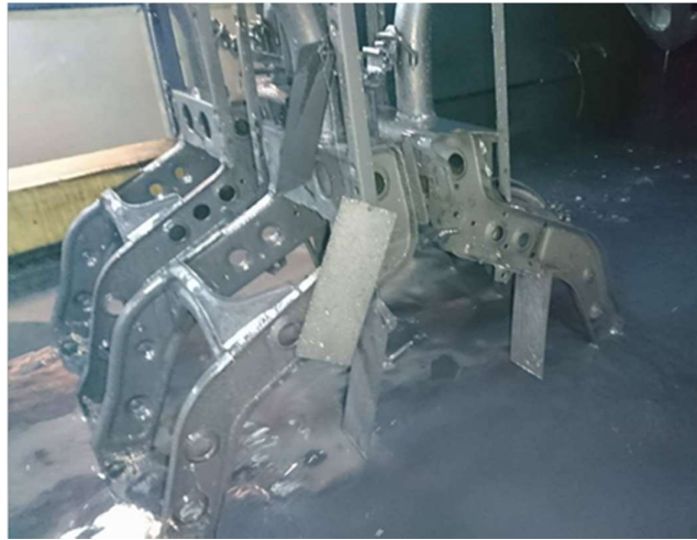
Hình 2.7. Sơn tĩnh điện cho các mẫu thép sau quá trình thụ động
